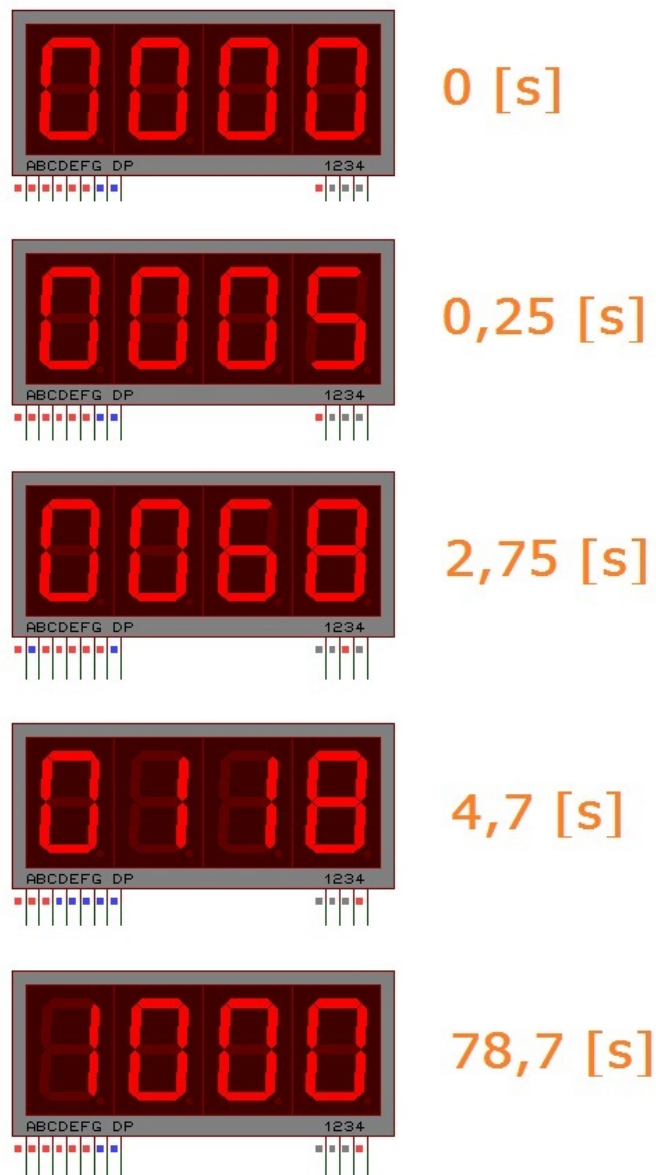
Slika 5.14 Simulacija mikrokontrolerske aplikacije "Brojač 0-1000"
