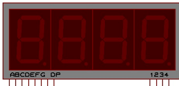
Slika 5.6 Komponenta multipleksiranih 7-segmentnih ekrana
