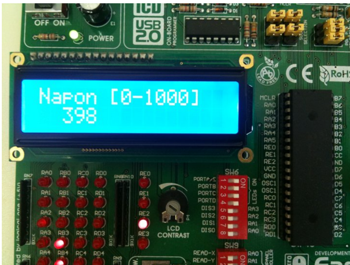
Slika 5.16 LCD ekran na razvojnom sustavu EasyPIC5
